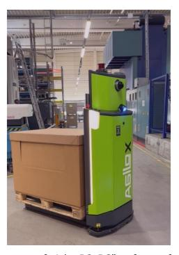
Der Auftrag an den Roboter wird digital übertragen, worauf sich "R2-D2" sofort auf den Weg macht, um die Ladungsträger zum einprogrammierten Ziel zu befördern, wobei er immer die für ihn optimale Route wählt.
